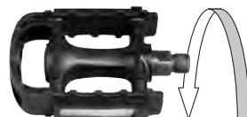
Linkes Pedal: Das linke Pedal ist an der Achse mit dem Buchstaben L gekennzeichnet. Die Schrauben werden entgegen dem Uhrzeigersinn festgezogen. Schmieren Sie das Gewinde der Pedale.
