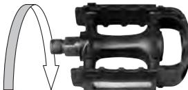
Pedale destro: Il pedale destro viene contrassegnato sull'asse dalla lettera R. Avvitare le viti in senso orario.
