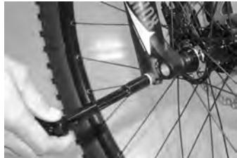
Si la palanca no se deja cerrar completamente, ábrala de nuevo y gírela un poco en sentido contrario a las agujas del reloj. Intente cerrar otra vez la palanca del cierre rápido.
