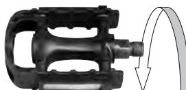
Pedal esquerdo: O pedal esquerdo tem um sinal no eixo com a letra L. Apertar os parafusos no sentido contrário ao dos ponteiros do relógio. Lubrifique a rosca dos pedais.
