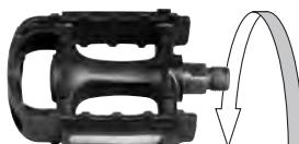
Pédale de gauche : La pédale de gauche est marquée sur son axe de la lettre L. Serrez les vis dans le sens inverse des aiguilles d'un montre. Graissez l'écrou des pédales.
