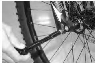
Qualora non fosse possibile chiudere completamente la leva, aprirla nuovamente e ruotarla leggermente in senso antiorario. Riprovare nuovamente a chiudere la leva a chiusura rapida.
