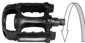
Pedale sinistro: Il pedale sinistro viene contrassegnato sull'asse dalla lettera L. Avvitare le viti in senso anti-orario. Lubrificare la vite di fissaggio dei pedali.
