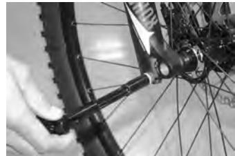
poussez le levier de blocage rapide E-Thru ouvert à travers la patte et le moyeu.
