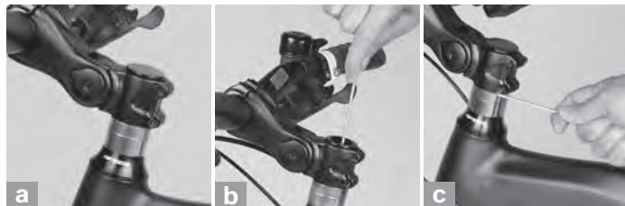
**⚠** Assurez-vous de régler correctement la position de la potence. Placez la roue avant entre vos jambes et essayez de tourner le guidon. Un réglage incorrect peut entraîner des chutes.
