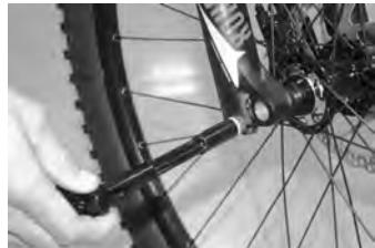
sites) trifft, drehen Sie die Achse im Uhrzeigersinn. Die Steckachse muss sich während der ersten Windungen frei drehen lassen.
