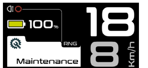
Recordatorio de mantenimiento.
