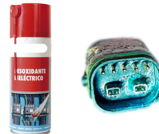
⚠ Lorsqu'un branchement électrique entre en contact avec de l'humidité ou qu'il se retrouve bouché en raison d'un agent polluant extérieur, une réaction chimique se produit et les raccordements sont soumis à un phénomène de sulfatation. Le cuivre des contacts s'oxyde et provoque des problèmes de conductivité.
