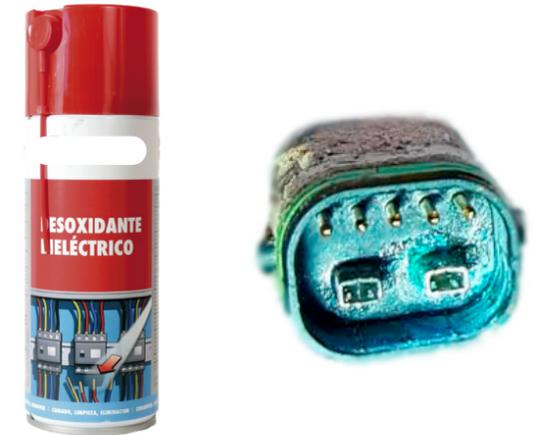
⚠ Cuando una conexión eléctrica entra en contacto con humedad o está tupidada debido a una contaminación externa, se produce una reacción química por la cual las conexiones se sulfatan. Es decir, el cobre de los contactos se oxida, provocando fallos de conductividad.
